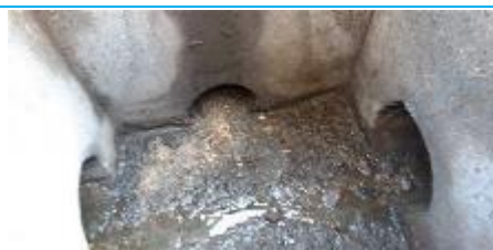
Matériaux : ZPSO-102 Prélèvement : P102 Description : Réseau EU - Conduit en ciment + béton Localisation : EME - Fontainebleau - Zone 2 Résultat : Absence d'amiante
