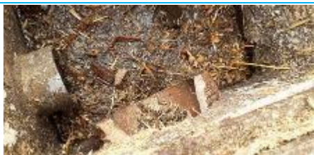
Matériaux : ZPSO-033 Prélèvement : P033 Description : Réseau EU - Conduit en céramique Localisation : EME - Fontainebleau - Zone 1 Résultat : Absence d'amiante
