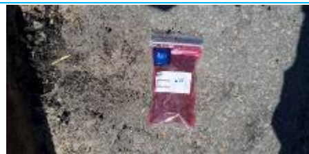
Matériaux : ZPSO-148 Prélèvement : P148 / C16 Description : Enrobé bitumineux des couches de voirie (juste partie bitume) Localisation : EME - Fontainebleau - Zone 2 Résultat : Absence d'amiante
