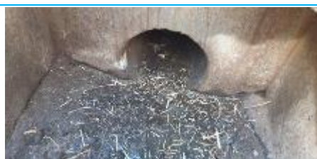
Matériaux : ZPSO-106 Prélèvement : P106 Description : Réseau EU - Conduit en ciment + béton Localisation : EME - Fontainebleau - Zone 2 Résultat : Absence d'amiante
