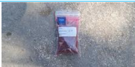
Matériaux : ZPSO-139 Prélèvement : P139 / C7 Description : Enrobé bitumineux des couches de voirie (juste partie bitume) Localisation : EME - Fontainebleau - Zone 2 Résultat : Absence d'amiante
