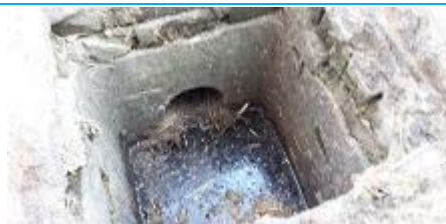
Matériaux : ZPSO-086 Prélèvement : P086 Description : Réseau EU - Parois verticales intérieures - Enduit ciment Localisation : EME - Fontainebleau - Zone 2 Résultat : Absence d'amiante
