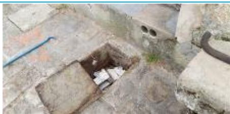
Matériaux : ZPSO-065 Prélèvement : P065 Description : Réseau EU - Parois verticales intérieures murs brique - Joint d'assemblage ciment Localisation : EME - Fontainebleau - Zone 2 Résultat : Absence d'amiante
