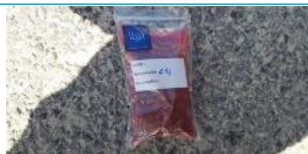
Matériaux : ZPSO-146 Prélèvement : P146 / C14 Description : Enrobé bitumineux des couches de voirie (juste partie bitume) Localisation : EME - Fontainebleau - Zone 2 Résultat : Absence d'amiante
