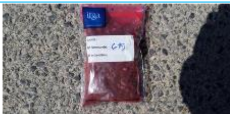
Matériaux : ZPSO-147 Prélèvement : P147 / C15 Description : Enrobé bitumineux des couches de voirie (juste partie bitume) Localisation : EME - Fontainebleau - Zone 2 Résultat : Absence d'amiante
