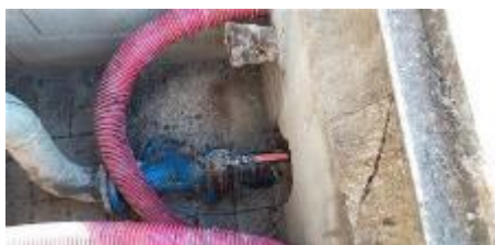
Matériaux : ZPSO-041 Prélèvement : P041 Description : Réseau AE - Conduit dur fibreux Localisation : EME - Fontainebleau - Zone 1 Résultat : Absence d'amiante
