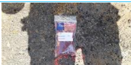
Matériaux : ZPSO-145 Prélèvement : P145 / C13 Description : Enrobé bitumineux des couches de voirie (juste partie bitume) Localisation : EME - Fontainebleau - Zone 2 Résultat : Absence d'amiante
