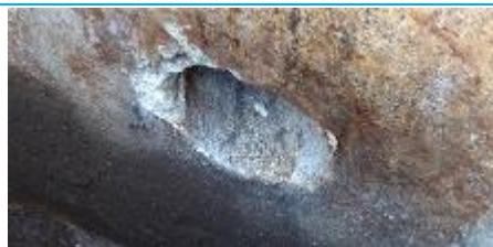
Matériaux : ZPSO-026 Prélèvement : P026 Description : Réseau EU - Conduit en ciment + béton Localisation : EME - Fontainebleau - Zone 1 Résultat : Absence d'amiante
