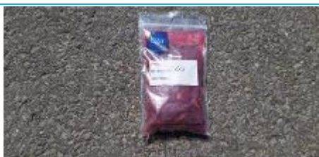
Matériaux : ZPSO-141 Prélèvement : P141 / C9 Description : Enrobé bitumineux des couches de voirie (juste partie bitume) Localisation : EME - Fontainebleau - Zone 2 Résultat : Absence d'amiante
