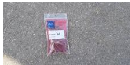
Matériaux : ZPSO-140 Prélèvement : P140 / C8 Description : Enrobé bitumineux des couches de voirie (juste partie bitume) Localisation : EME - Fontainebleau - Zone 2 Résultat : Absence d'amiante
