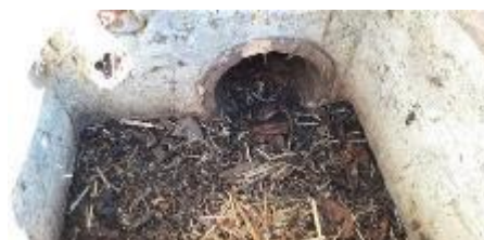
Matériaux : ZPSO-030 Prélèvement : P030 Description : Réseau EU - Conduit en céramique Localisation : EME - Fontainebleau - Zone 1 Résultat : Absence d'amiante
