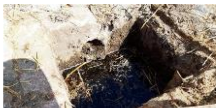
Matériaux : ZPSO-088 Prélèvement : P088 Description : Réseau EU - Conduit en ciment + béton Localisation : EME - Fontainebleau - Zone 2 Résultat : Absence d'amiante
