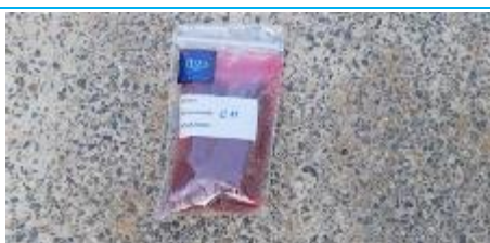
Matériaux : ZPSO-143 Prélèvement : P143 / C11 Description : Enrobé bitumineux des couches de voirie (juste partie bitume) Localisation : EME - Fontainebleau - Zone 2 Résultat : Absence d'amiante
