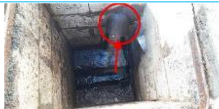
Matériaux : ZPSO-034 Prélèvement : P034 Description : Réseau EU - Conduit en fibres-ciment Localisation : EME - Fontainebleau - Zone 1 Résultat : Présence d'amiante
