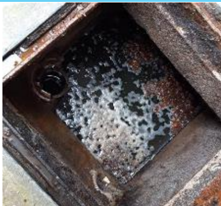
Matériaux : ZPSO-029 Prélèvement : P029 Description : Réseau EU - Conduit en céramique Localisation : EME - Fontainebleau - Zone 1 Résultat : Absence d'amiante
