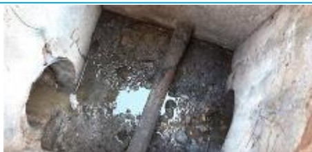
Matériaux : ZPSO-103 Prélèvement : P103 Description : Réseau EU - Revêtement dur bitumineux noir sur conduit métallique Localisation : EME - Fontainebleau - Zone 2 Résultat : Absence d'amiante
